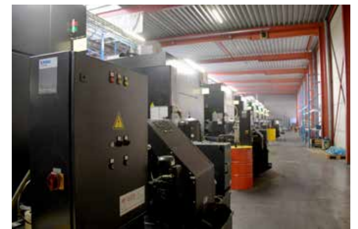
Binnen de gebouwen van Schramme Industries verrees een state-of-the-art volautomatische freeslijn waarin acht freesmachines en alle nodige tooling en materialen in vevat zitten.
